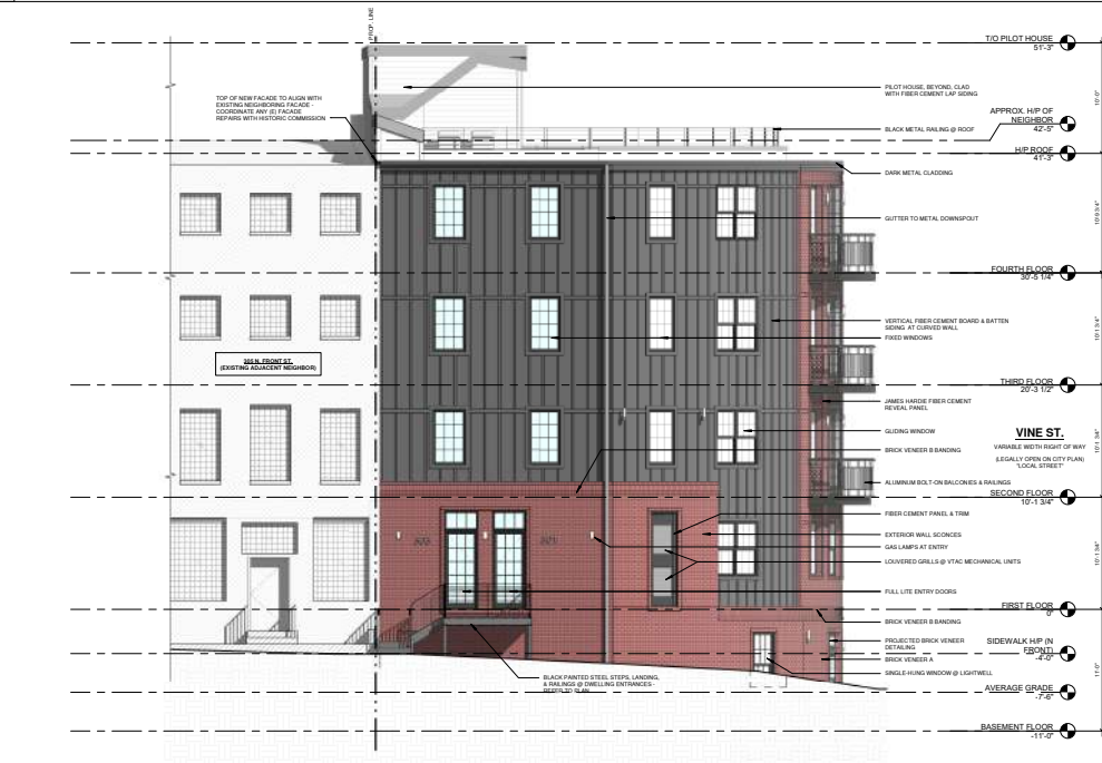
2 N. WATER STREET ELEVATION SCALE: 3/8" = 1'-0"
